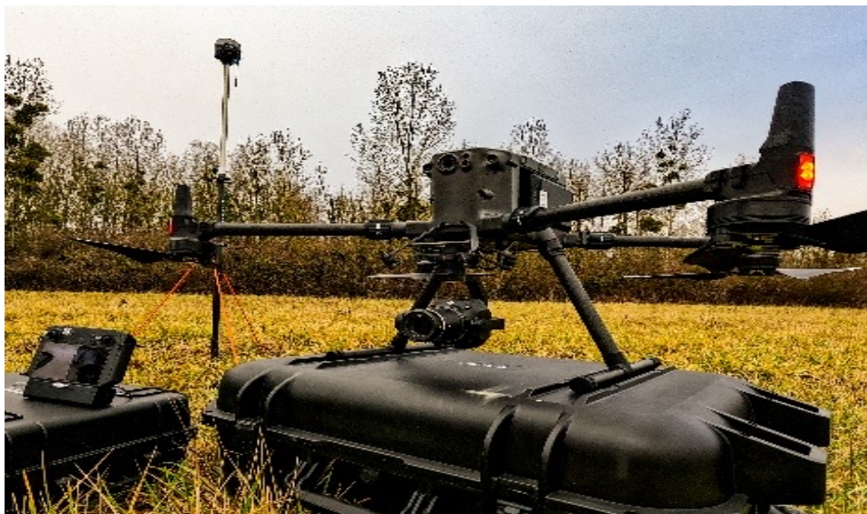
Drone Matrice 300 RTK de DJI avec base GNSS au sol
